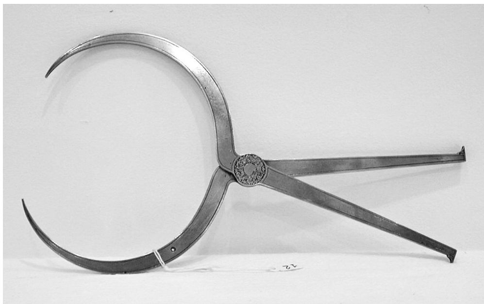
N° 12 – Compasso per misurare i diametri delle palle
